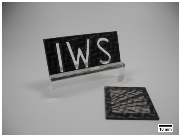
Remote laserstrahlgeschnittener glasfaserverstärkter Kunststoff sowie definierter oberflächiger Matrixabtrag © Fraunhofer IWS Dresden
